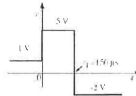
4. Considere o circuito representado na figura, no qual  $i(t)$  é uma corrente periódica com frequência de 1kHz e tem a forma indicada. Admitindo que o valor médio de  $V_c(t)$  é de 2V, calcule os seus valores máximo e mínimo e represente graficamente  $V_c(t)$ ,  $V_R(t)$  e  $V_1(t)$ .
